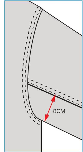
WASHCARE LABEL INSERTED AT INTERNAL LHS SIDeseam, 5CM UP RIB SEAM.
