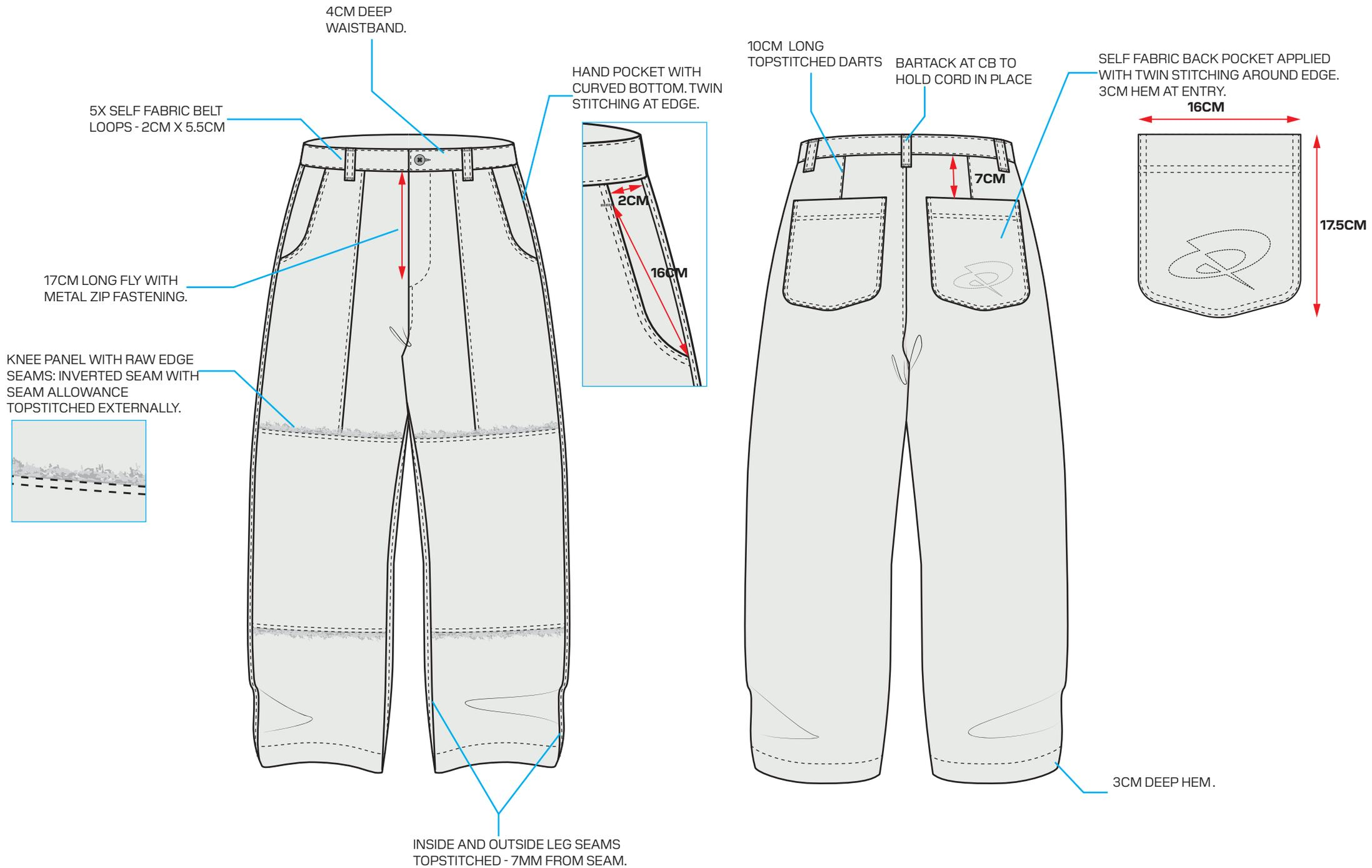
WASHCARE LABEL INSERTED AT INTERNAL LHS SIDESEAM, 10CM DOWN FROM WAISTBAND SEAM.
